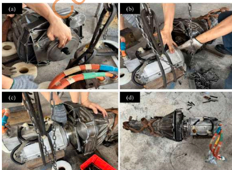
รูปที่ 10.21 ขั้นตอนการประกอบมอเตอร์เข้ากับชุดเกียร์
