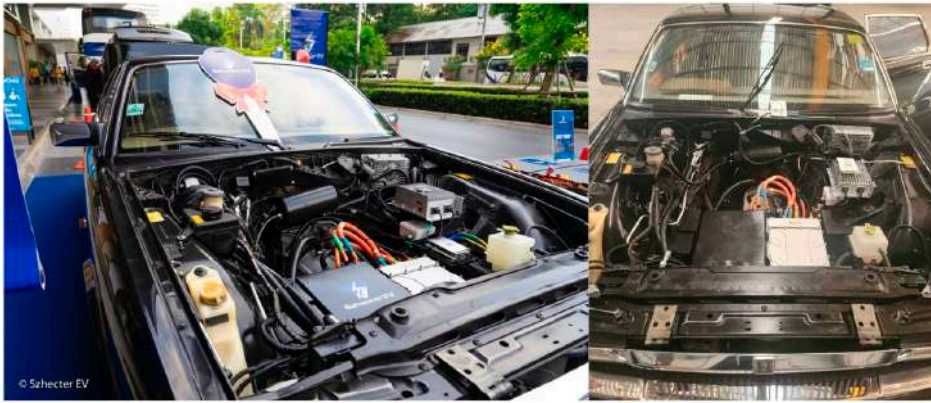
รูปที่ 10.20 เครื่องยนต์สันดาปภายในได้ถูกถอดออกแล้ว
